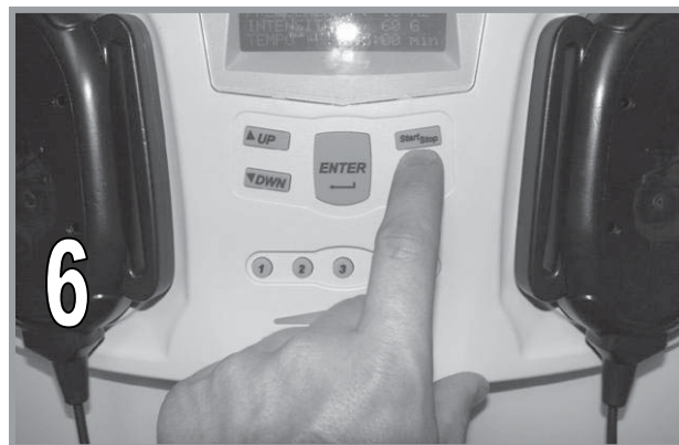
Avviare il trattamento tramite il tasto "START/STOP" al termine della terapia, l'erogazione si fermerà automaticamente e si tornerà al menu principale
