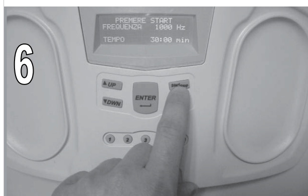
6 Avviare il trattamento tramite il tasto “START/STOP” Il trattamento continuerà fino ad una nuova pressione del tasto “START/STOP”
