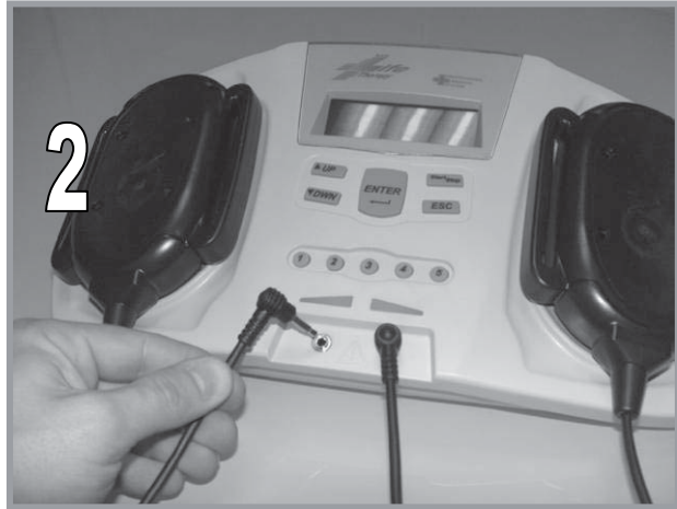
Collegare 1 o 2 applicatori a seconda del trattamento (vedere le immagini dei trattamenti)
