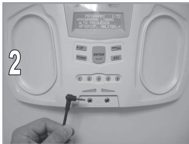
2 Collegare il cavetto proveniente dalla stuoia
